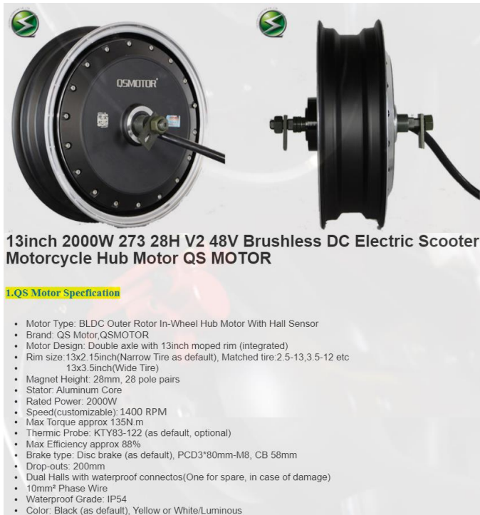
Gambar 4. 16 Spesifikasi QS 2000W 273 28H V2 72V BLDC Hub Motor
