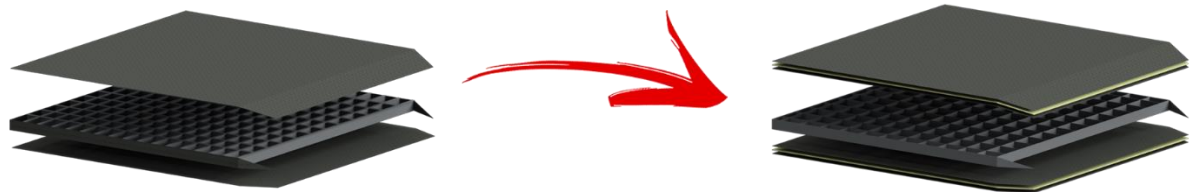
Gambar 3.4 Ilustrasi pengaplikasian konstruksi sandwich panel pada ramp door kapal.
