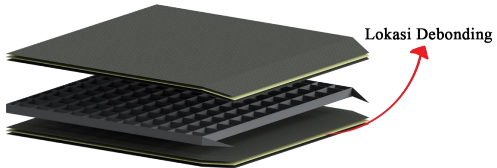
Gambar 3.17 Lokasi debonding pada model sandwich panel
