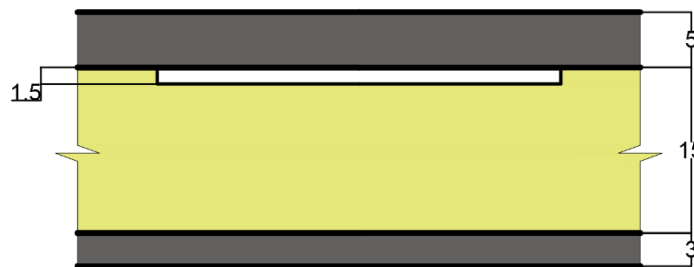
Gambar 3.18 Tebal kerusakan debonding
