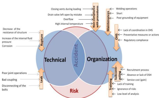
Gambar 2.2 Diagram venn tentang fakta-fakta yang mengarah pada kecelakaan yang melibatkan bejana tekan
