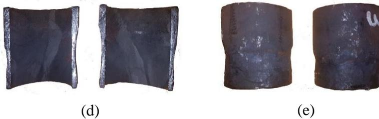
**Gambar 3. 4** Hasil potongan sampel pipa, (a) potongan 1, (b) potongan 2, (c) potongan 4, (d) potongan 3 bagian dalam, (e) potongan 3 bagian luar.
