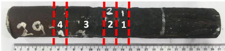
**Gambar 3. 3** lokasi pemotongan sampel untuk pengujian
