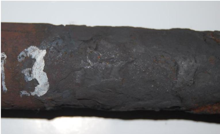
**Gambar 1. 4** Failure yang terjadi pada Waste Heat Boiler Tube
