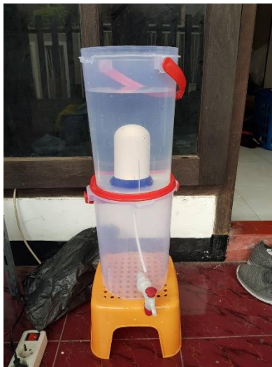
Gambar 4. 4. Reaktor F2 (Filter Membran Keramik). Sumber: Dokumen Pribadi.
