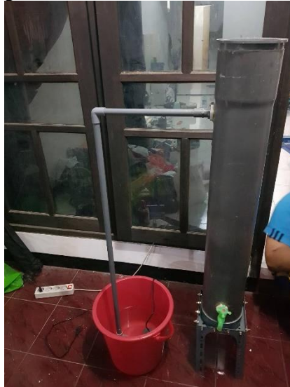
Gambar 4. 3. Reaktor F1 (Filter Organik). Sumber: Dokumen Pribadi.
