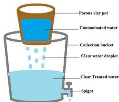
Gambar 2. 10. Membran filter keramik berbentuk pot
