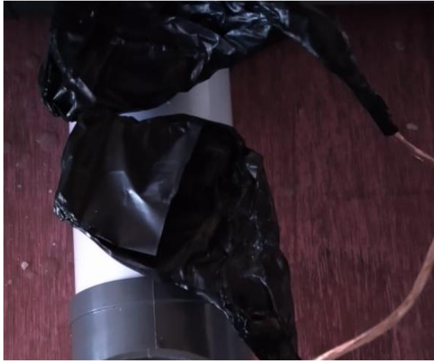
Gambar 4. 22. Loudspeaker yang Dilapisi dengan Plastik Sumber : Dokumentasi Pribadi
