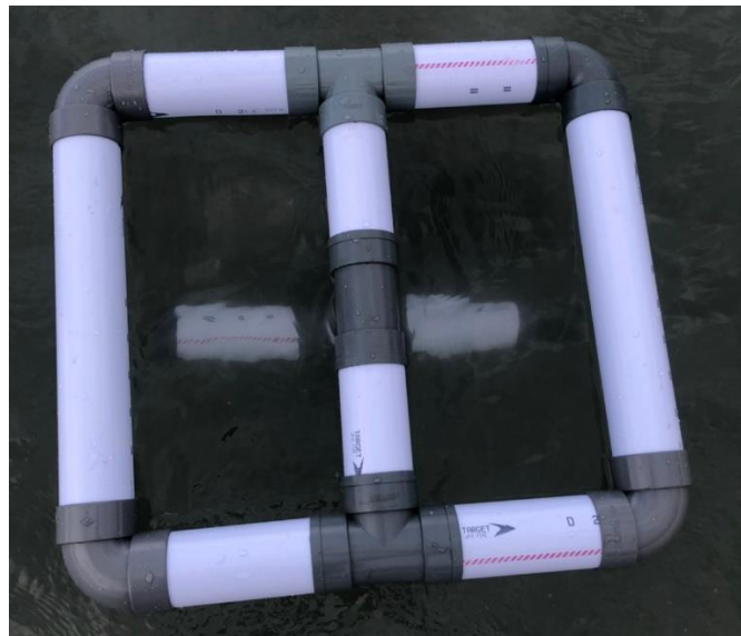
Gambar 4. 27. Ponton Pipa PVC Sumber : Dokumentasi Pribadi
