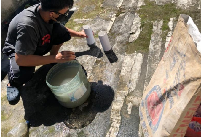
Gambar 4. 18. Proses Pengeringan Semen Selama 24 Jam Sumber : Dokumentasi Pribadi
