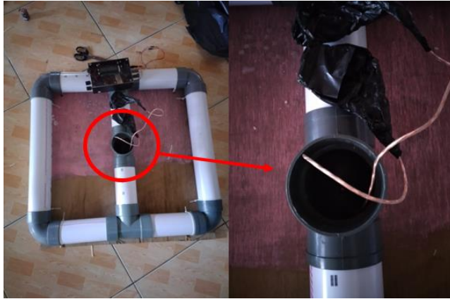
Gambar 4. 21. Instalasi Kabel Loudspeaker pada Bagian Bawah Ponton Sumber : Dokumentasi Pribadi
