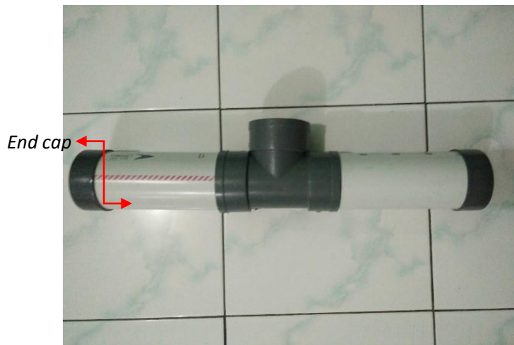
Gambar 4. 16. Bagian Bawah Ponton Sumber : Dokumentasi Pribadi
