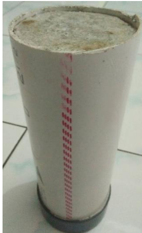
Gambar 4. 8. Pipa PVC Berisi Semen Sumber : Dokumentasi Pribadi
