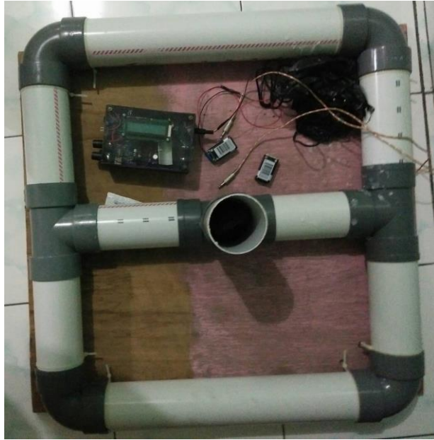
Gambar 4. 15. Pipa PVC Berbentuk Ponton Persegi Sumber : Dokumentasi Pribadi
