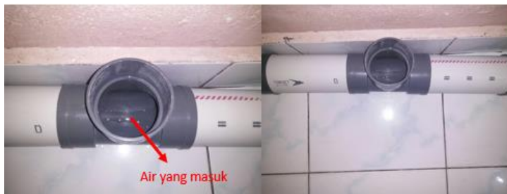
Gambar 4. 28. Air yang Masuk dari Bagian Bawah Ponton ke Dalam Tabung Pipa PVC Selama Proses Pengujian Sumber : Dokumentasi Pribadi
