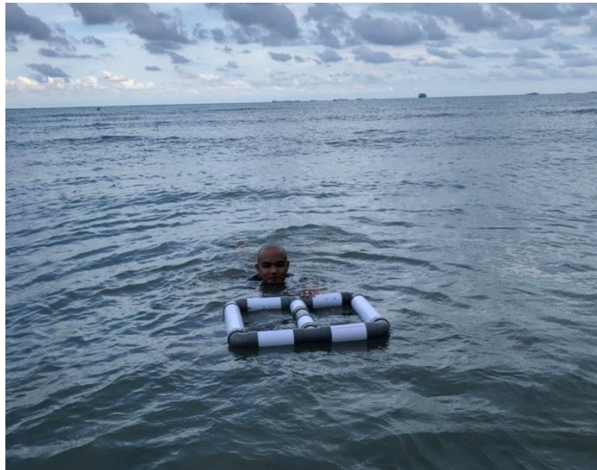
Gambar 4. 26. Pengujian Kekedapan Air Ponton Pipa PVC Sumber : Dokumentasi Pribadi
