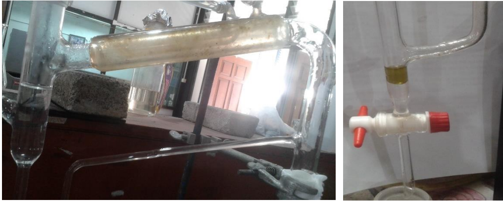
Contoh Fenomena Terbentuknya Dua Lapisan Ekstrak pada Clevenger
