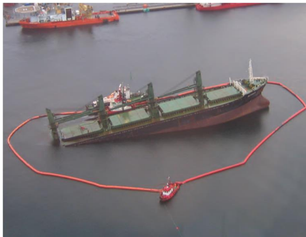
Gambar 4. 11 Contoh penggunaan oil boom untuk mencegah penyebaran minyak dari kecelakaan kapal
