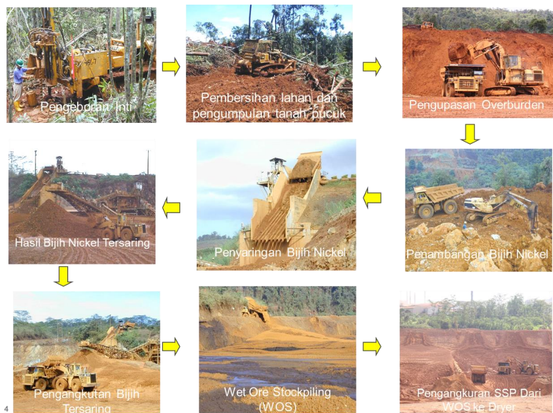
Gambar 2.2.1 Tahapan Proses Penambangan Bijih Nickel (data perusahaan)
