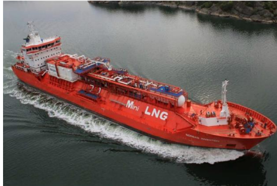
Gambar 2. 5 Kapal Pengangkut LNG 10000 m 3 (Norgas) Sumber : (PT Golar Indoensia, 2019)
