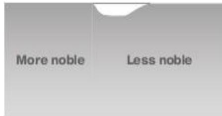
**Gambar 2.9** Struktur Korosi Galvanis
