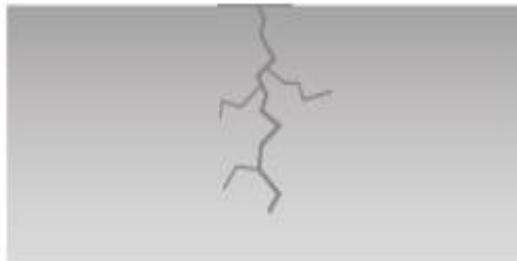
**Gambar 2.11** Struktur Korosi Tegangan
