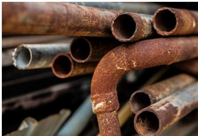
**Gambar 2.1** Korosi pada pipa
