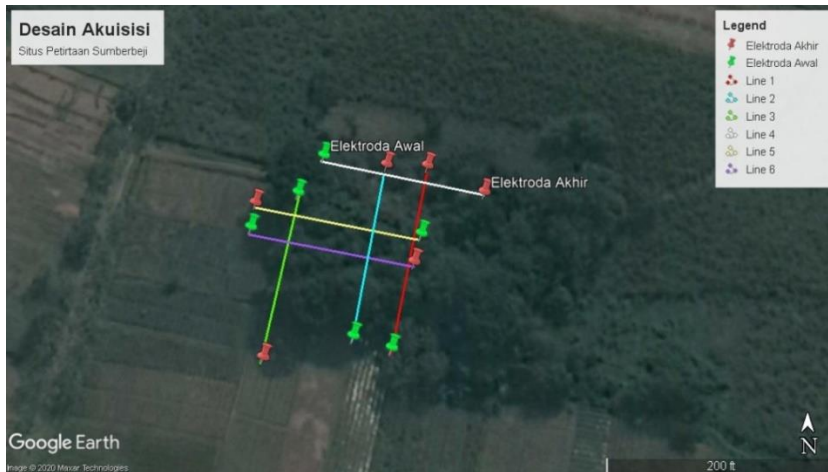
Gambar 3. 2 Desain akuisisi metode resistivity 2D
