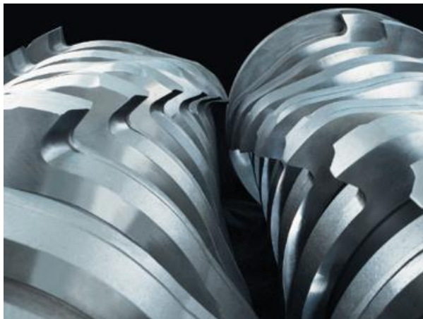
Gambar 2.2 Bilah peniras Sumber: Metso Mineral, 2000
