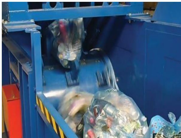
Gambar 2.3 Pembuka kantung Sumber: Matthiessen Engineering SARL, 2014
