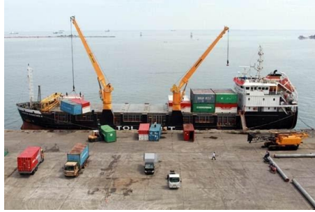
Gambar 2.14 Crane pada kapal Container
