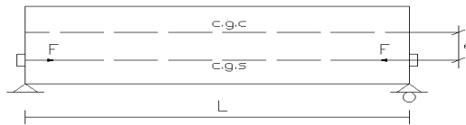
Gambar 2. 6 Tendon dengan Eksentrisitas (Lin dan Burns, 2000).
