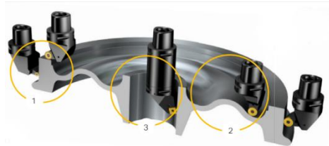
Gambar 2. 10 Machining pada bagian roda kereta (Sumber: Sandvik Coromant)
