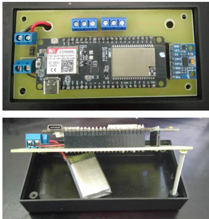
Gambar 3.5 Penampakan bagian luar dan dalam hardware purwarupa wearable
