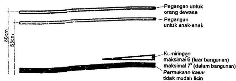
Gambar 2.2.3.2 Pegangan Rambat pada Ramp
