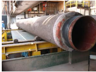
Gambar 4.19 Increase Wall/ Concrete Thickness (Sumber : [13] Perlindungan Pipa Bawah Laut)
