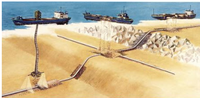
Gambar 4.22 Engineering Backfill (Sumber : [13] Perlindungan Pipa Bawah Laut)
