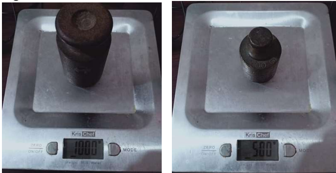
Gambar 4.7 Proses penimbangan beban mati 0.5 kg dan 1.0 kg
