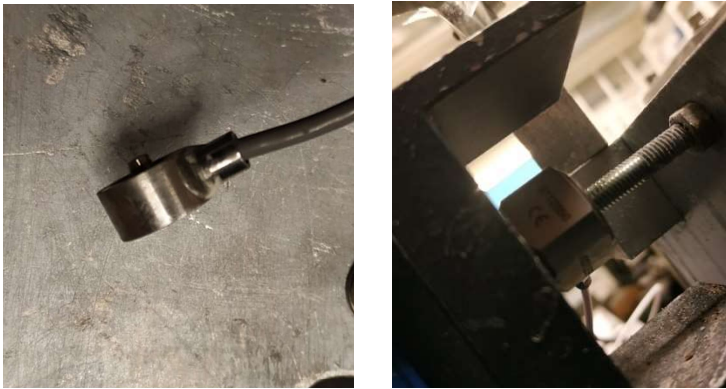
Gambar 2.15 Sensor pada tribometer resmat. Kiri: Compression button load cell , kanan: Inline Tension-Compression load cell .
