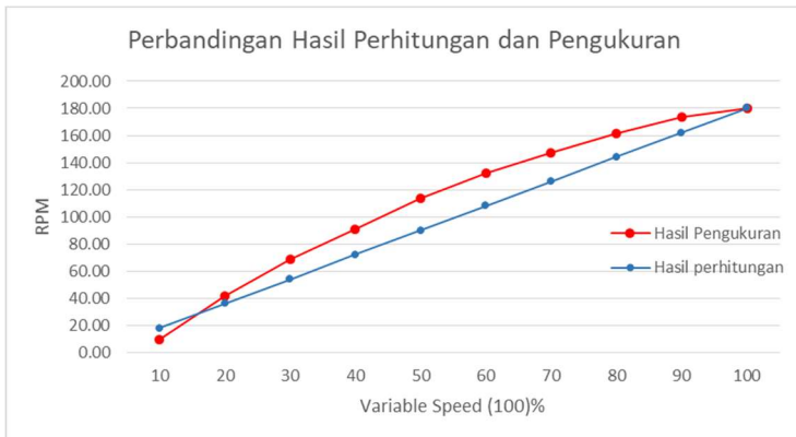
Gambar 4.14 Grafik hasil perbandingan kecepatan motor perhitungan dan pengukuran
