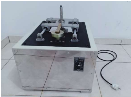
Gambar 4.1 Hasil akhir rancang bangun Tribometer
