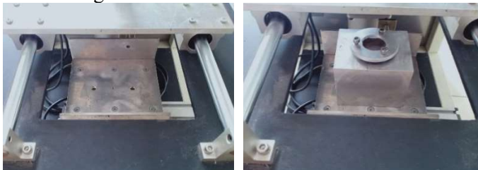
Gambar 5.2 Pemasangan specimen holder pada base
