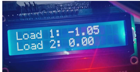
Gambar 4.8 Hasil pengukuran ke-1 dengan beban 1kg pada indikator Arduino
