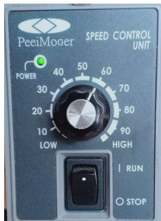
Gambar 5.6 Panel kecepatan motor dan saklar RUN/STOP
