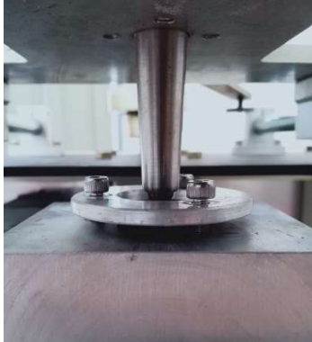
Gambar 5.3 Memposisikan pin tepat di atas spesimen
