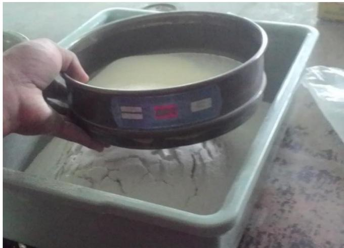
Gambar 3.4 Proses penyaringan serbuk cangkang kerang dan cangkang telur
