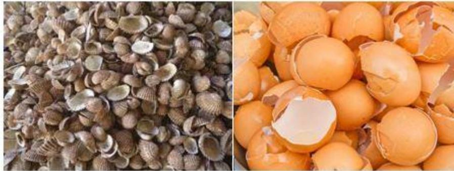
Gambar 2.8 Cangkang kerang (kiri) dan cangkang telur (kanan) yang digunakan sebagai *filler*
