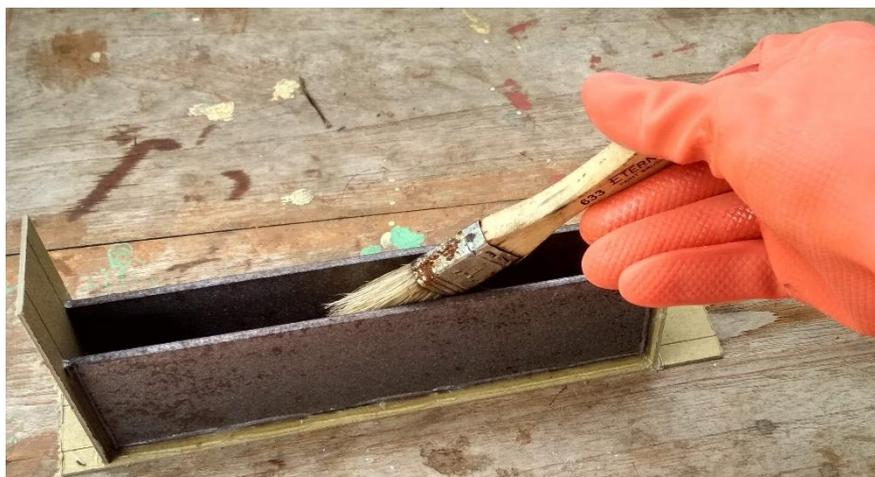
Gambar 3.12 Pengaplikasian *epoxy resin* pada cetakan
