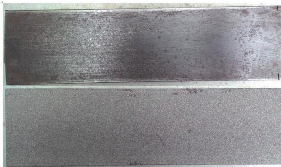
Gambar 3.3 Perbandingan pelat sebelum (atas) dan sesudah dilakukan *sandblasting* (bawah)
