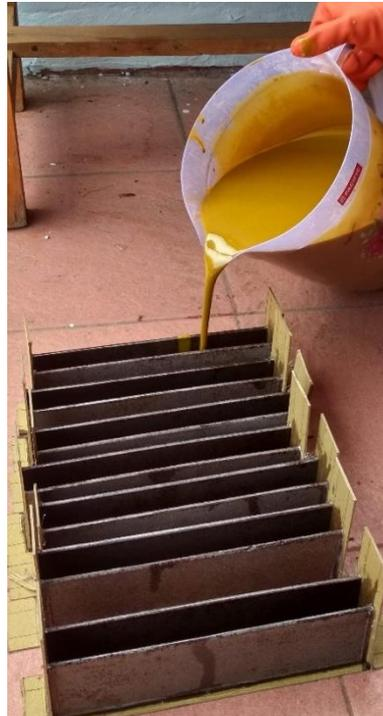
Gambar 3.16 Penuangan campuran *core material* ke dalam cetakan
