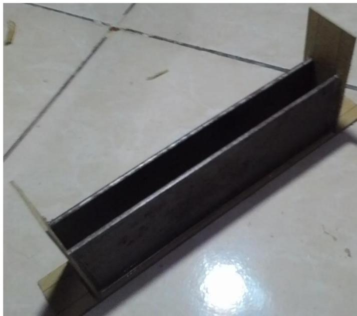
Gambar 3.10 Cetakan spesimen *sandwich material*
