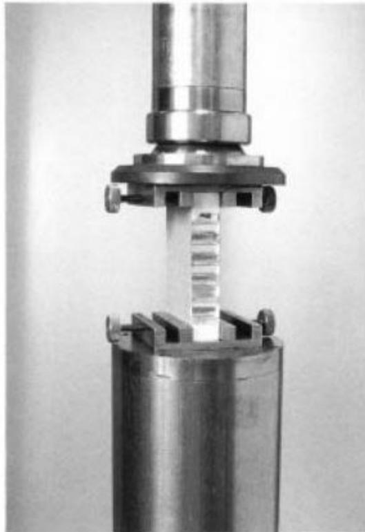
Gambar 2.17 Set up perlengkapan pengujian *buckling* (ASTM, 1999)
