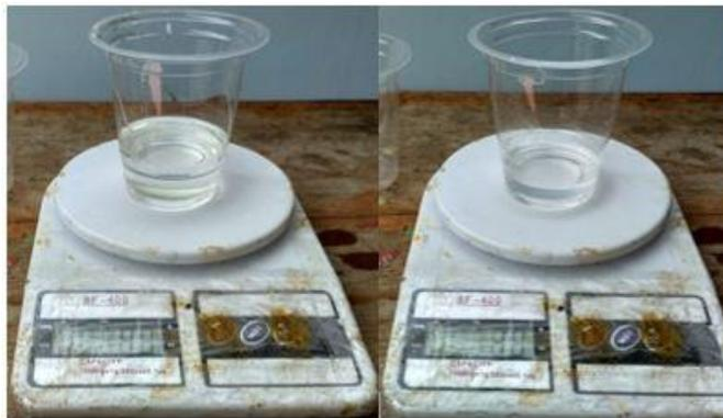
Gambar 3.11 Penimbangan *epoxy resin* (kiri) dan *hardener* (kanan)
