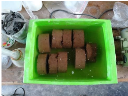
Gambar 3.10-4 Merendam benda uji untuk uji porositas
