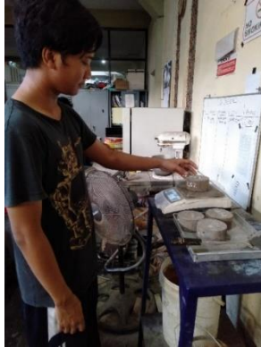
Gambar 3.10-4 Merendam benda uji untuk uji porositas
