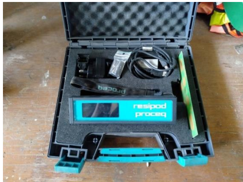
Gambar 3.10-2 Resipod, alat untuk menguji nilai resistivitas beton geopolimer
