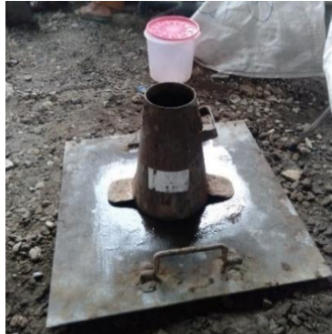
Gambar 3.10-1 Cone slump, alat untuk mengukur nilai slump
