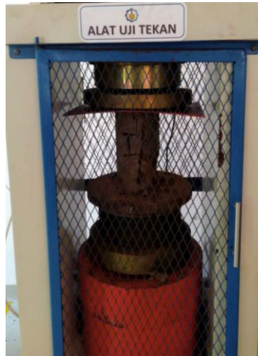
Gambar 3.10-6 Alat untuk menguji kuat tekan beton
