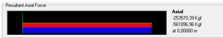
Gambar 8.19 Gaya aksial atas kolom (frame-1694)
