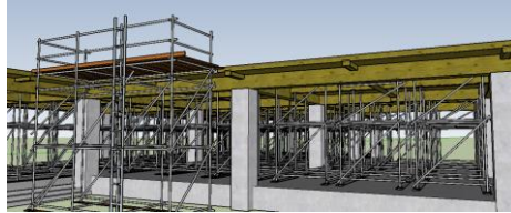
Gambar 10.5 Bekisting plat dan balok
