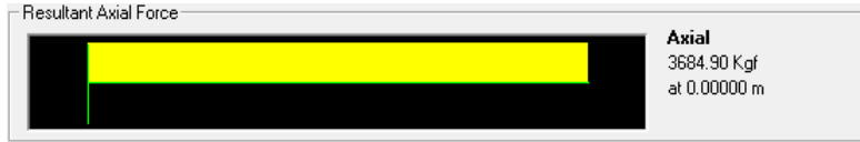
Gambar 8.4 Gaya aksial yang didapatkan dari SAP2000 dari kombinasi ultimate 1,2D + 1,6L
