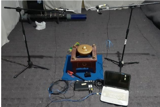
Gambar 3.5 Rangkaian alat pada pengujian bonang barung
