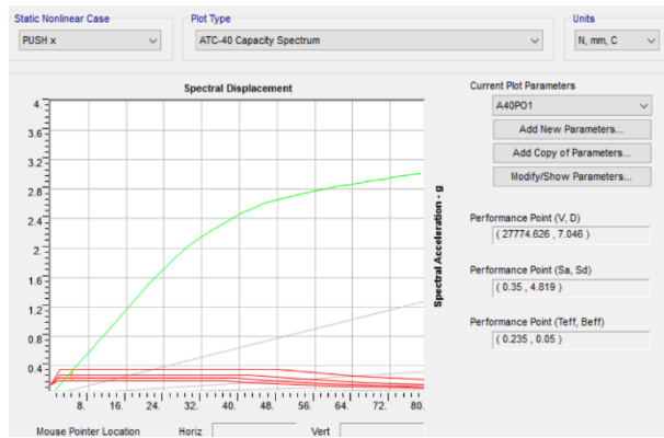
Gambar 4. 26 Kurva kapasitas arah X metode ATC-40 untuk KDS C Sumber: Dokumen penulis
