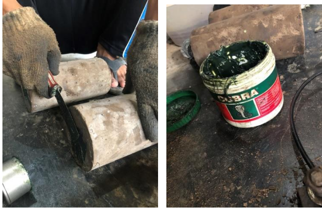
Gambar 3. 9 pengaplikasian stempet dan stempet yang digunakan (merk cobra)
