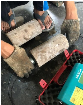
Gambar 3. 10 penggunaan alat upv pada benda uji
