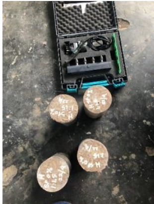
Gambar 3. 11 alat resistivity dan benda uji
