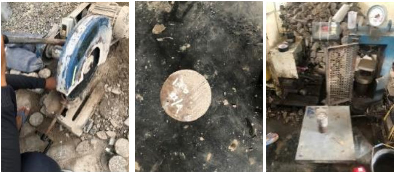
Gambar 3. 5 dari kiri kekanan a) penghalusan benda uji, b) hasil penghalusan benda uji, c) menimbang benda uji
