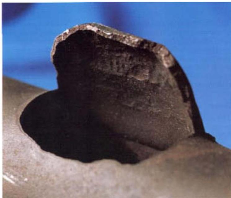
**Gambar 2. 4** Tube yang mengalami kegagalan akibat Hydrogen Damage [17]
