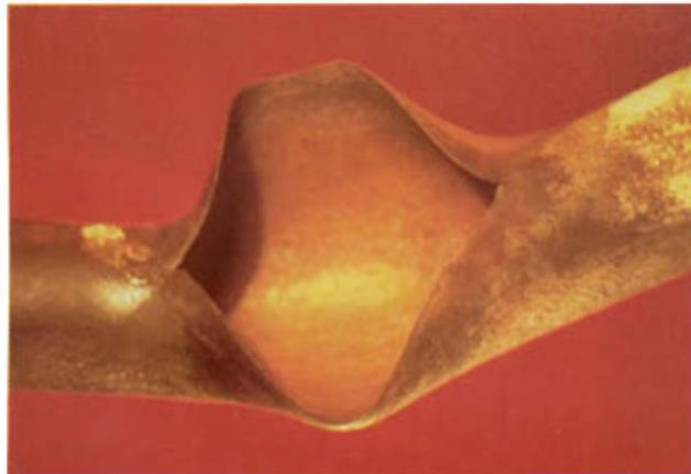
**Gambar 2. 13** Bentuk kegagalan dengan mekanisme short term overheating pada tube [17]
