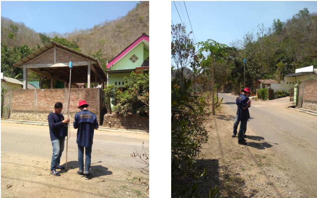
Gambar 3.2 Pengumpulan data magnetik dalam survei magnetik di lapangan dengan menggunakan Geoprotom magnetometer sebagai portable instrument .
