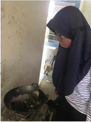
6. Campurkan agregat pada aspal panas
