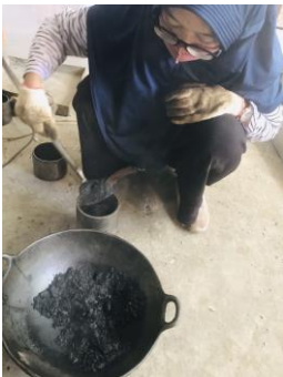
8. Masukkan Campuran Aspal pada Molding
