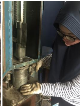
10. Tumbuk 75x untuk lapisan AC-BC
