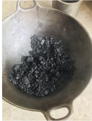
7. Campurkan agregat pada aspal panas sampai aspal menyelimuti semua agregat
