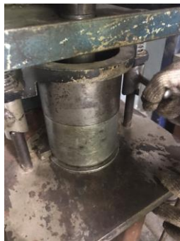
9. Pasang Molding pada alat compactor
