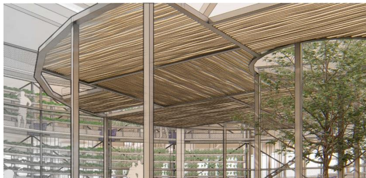
Gambar 4. 15 Ranting kayu jati sebagai secondary plafond (Sumber : Dokumen Pribadi,2020)
