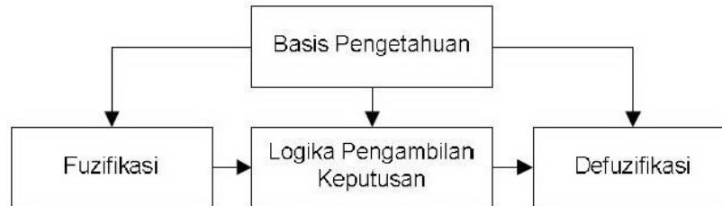
Gambar 2. 10 Struktur dasar pengendali fuzzy
