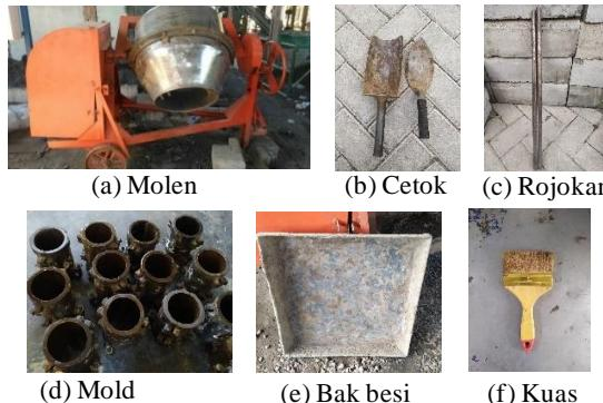
Gambar 3.5 Peralatan Pengecoran
