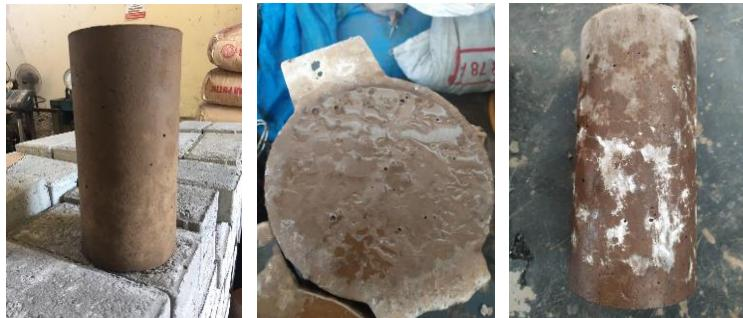
a. sampel tanpa permukaan karbonasi      b. sampel dengan hasil karbonasi ( $\text{H}_2\text{O}$ )      c. sampel dengan hasil karbonasi ( $\text{Na}_2\text{CO}_3$  dan  $\text{CaCO}_3$ )
