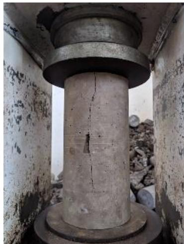
Gambar 3.10 Pengujian Kuat Tekan Beton
