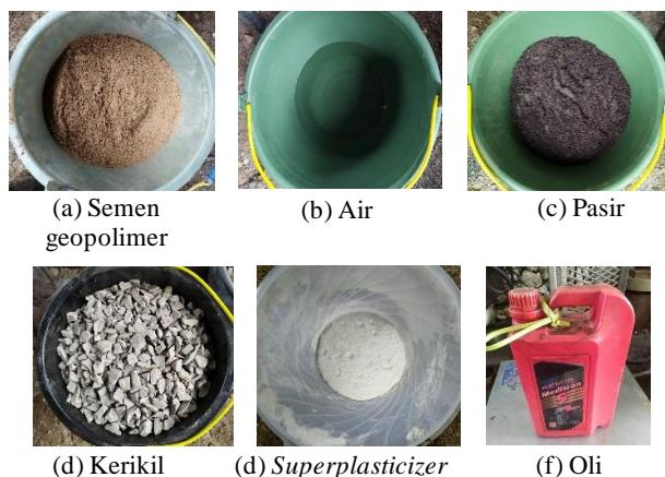
Gambar 3.6 Bahan Pengecoran
