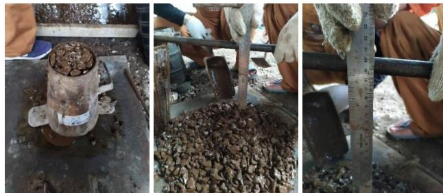
Gambar 3.9 Proses Pengukuran Slump
