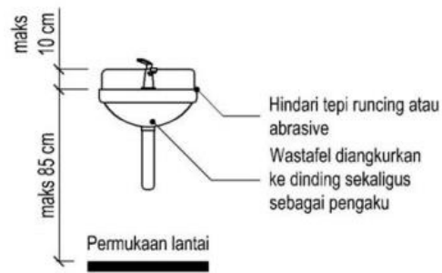
Gambar 2.3.1.4 : Ketinggian Wastafel untuk Disabilitas (Sumber : Menteri Pekerja Umum, Pedoman Teknis Fasilitas dan Aksesibilitas Pada Bangunan Gedung dan Lingkungan No. 30/PRT/M/2006, Indonesia)
