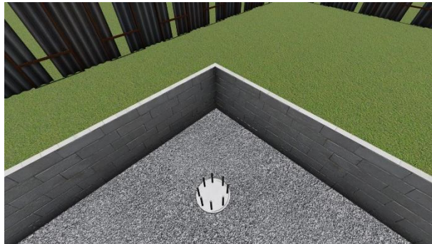
Gambar 5.55 Pemasangan Bekisting Raft
