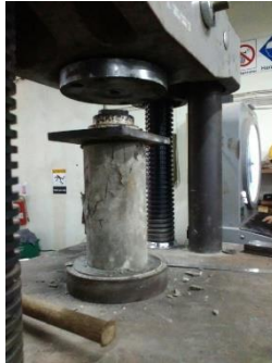
Gambar 5. 16 Uji Kuat Tekan Beton
