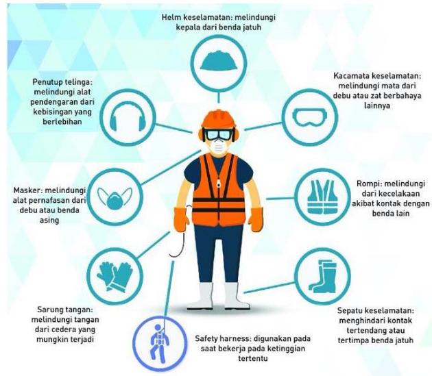
Gambar 2.26 Alat Pelindung Diri (APD) pada Proyek Konstruksi
