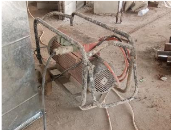
Gambar 2.17 Vibrator (Sumber: Dokumentasi Pribadi)
