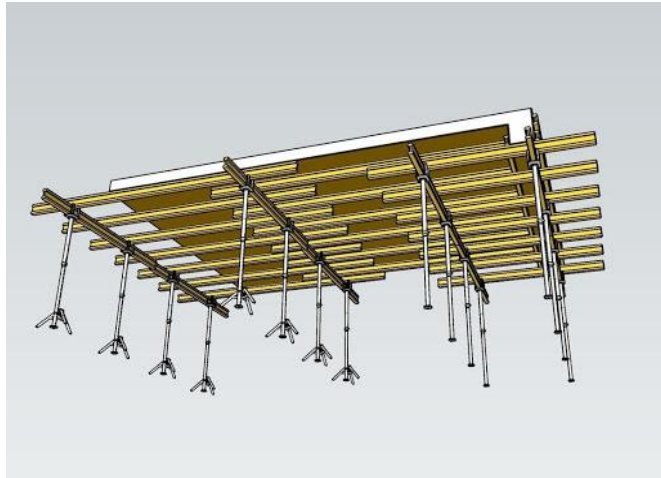
Gambar 6.2 Sketsa Bekisting Pelat Lantai
