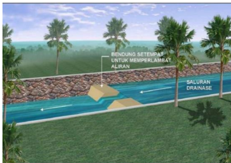
Gambar 2.5 Kolam retensi tipe storage memanjang
