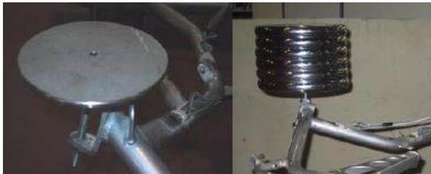
Gambar 2. 23 Pembebanan pada eksperimen Solazzi & Matteazi.
