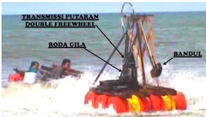
Gambar 2. 21 Pembangkit Listrik Tenaga Gelombang Laut Sistem Bandul Zamrisyaf. [4]
