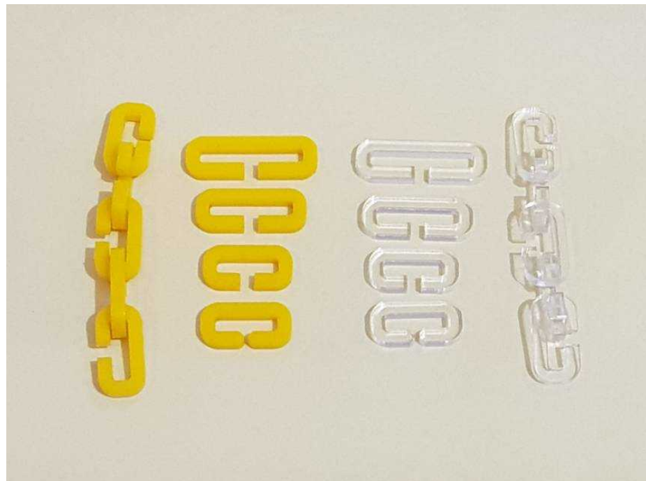
Gambar 4.84: Hasil Uji Coba Potongan Rantai Akrilik. (Sumber: Olahan Penulis, 2020)
