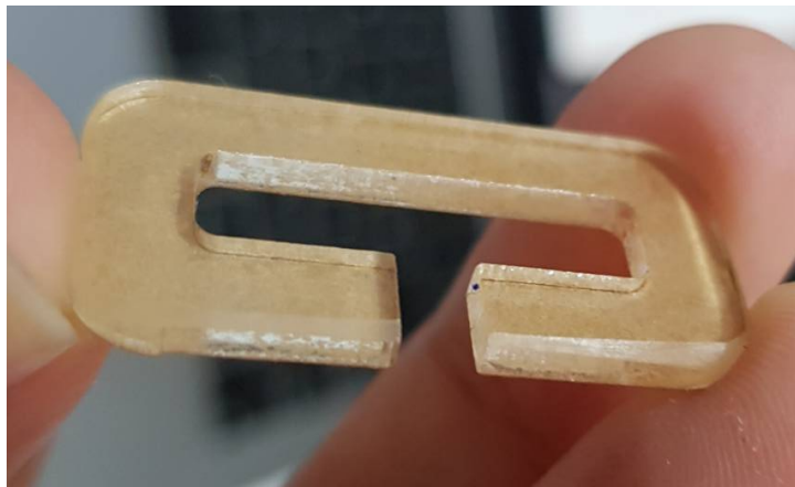
Gambar 4.155: Hasil Perbaikan Produk Dalam Menghilangkan Sudut Pada Pinggiran Potongan Akrilik. (Sumber: Olahan Penulis, 2020)
