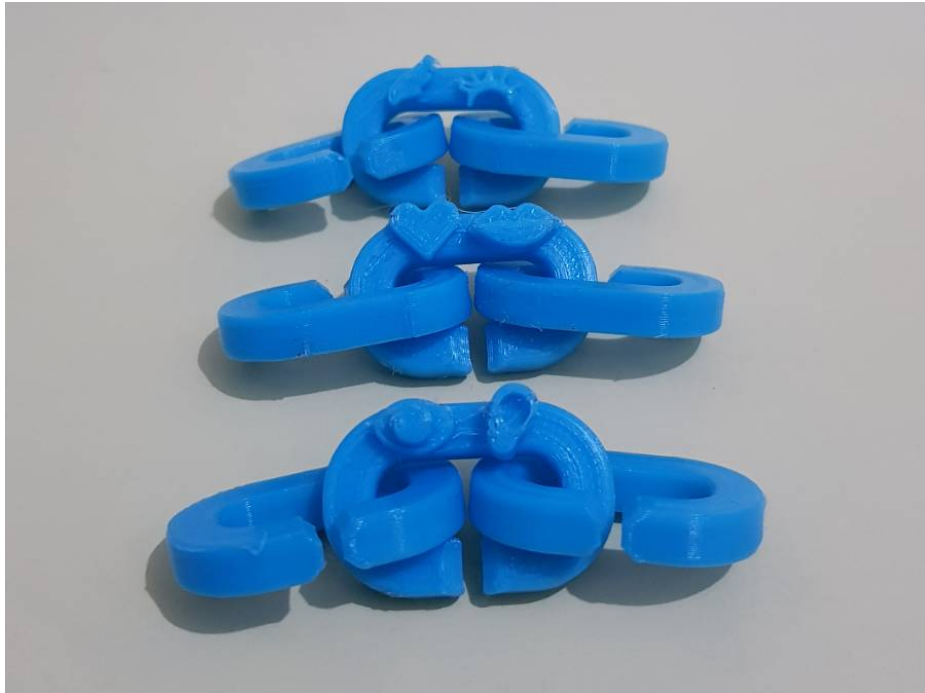
Gambar 4.65: Hasil Uji Coba Material Plastik Pada Pengembangan Bentuk Komponen Rantai Persegi. (Sumber: Olahan Penulis, 2020)
