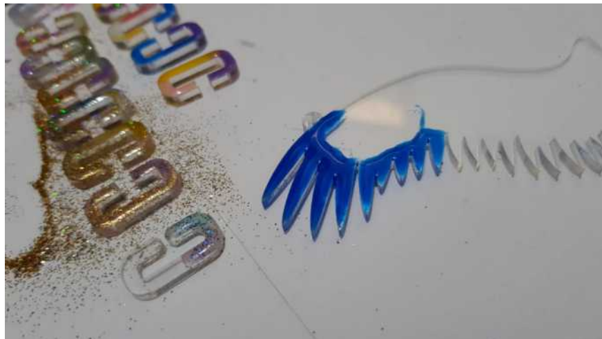
Gambar 4.124: Proses Pewarnaan Komponen Rantai Kecil, Pendant , Base dan Komponen Utama Anting-Anting Nonkustom. (Sumber: Olahan Penulis, 2020)
