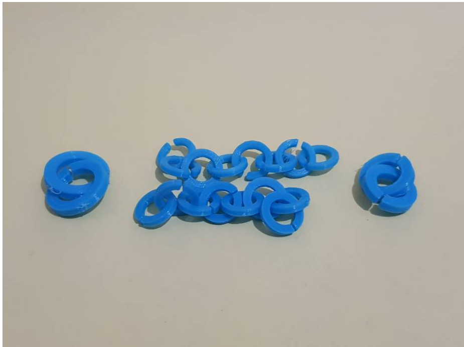
Gambar 4.66: Hasil Uji Coba Material Plastik Pada Komponen Penyambung Berbentuk Bulat. (Sumber: Olahan Penulis, 2020)
