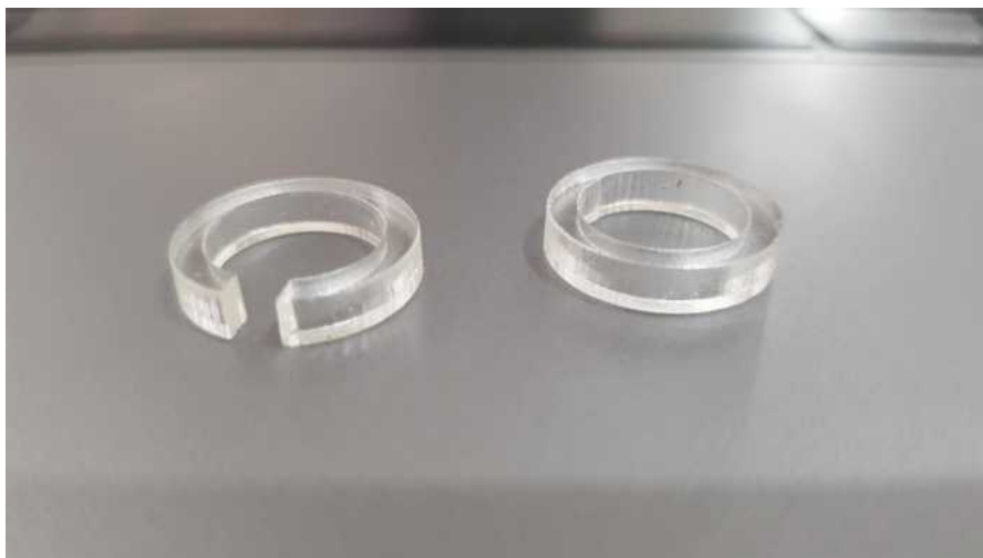
Gambar 4.158: Perbaikan Desain Komponen Penyambung. (Kiri: Desain Atau Prototipe Lama, Kanan: Desain Atau Prototipe Baru). (Sumber: Olahan Penulis, 2020)
