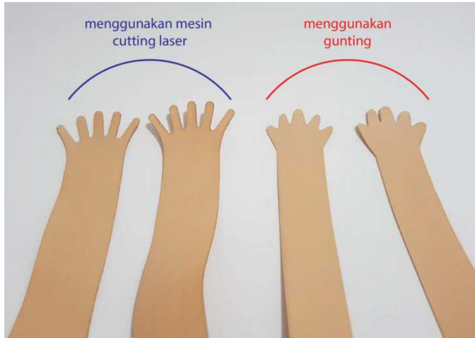
Gambar 4.55: Perbandingan Hasil Potongan Kulit Imitasi Menggunakan Mesin Cutting Laser dan Gunting. (Sumber: Olahan Penulis, 2020)
