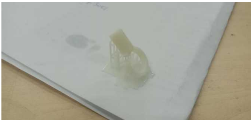
Gambar 4.133: Hasil Cetak Chain End Menggunakan 3D Print dan Material Resin. (Sumber: Olahan Penulis, 2020)
