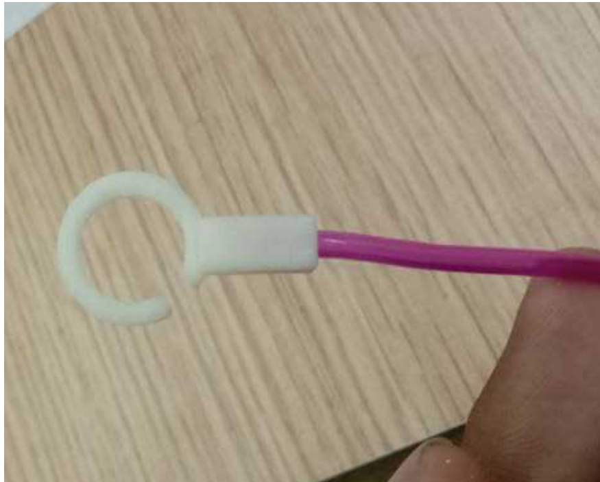
Gambar 4.136: Hasil Cetak dan Assembly Antara Chain End dan Tali (Selang Plastik). (Sumber: Olahan Penulis, 2020)
