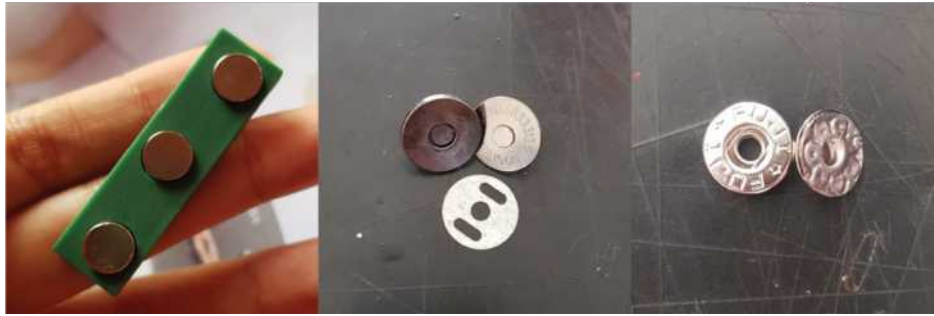
Gambar 4.58: Komponen Sistem Lepas Pasang Charm Pada Material Kulit Imitasi. (Dari Kanan Ke Kiri: Magnet, Kancing Magnet, dan Kancing Jamur) (Sumber: Olahan Penulis, 2020)
