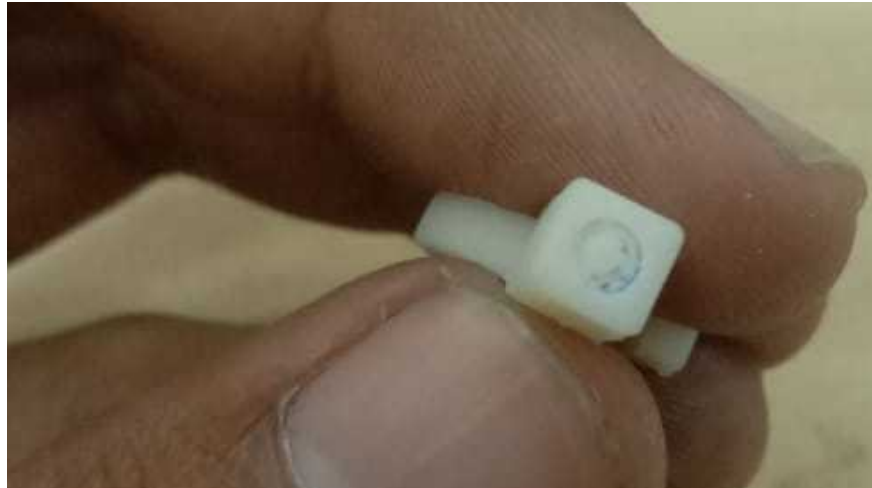
Gambar 4.134: Kegagalan Model Pertama Chain End yang Dicitak Menggunakan Mesin 3D Print dan Material Resin. (Sumber: Olahan Penulis, 2020)
