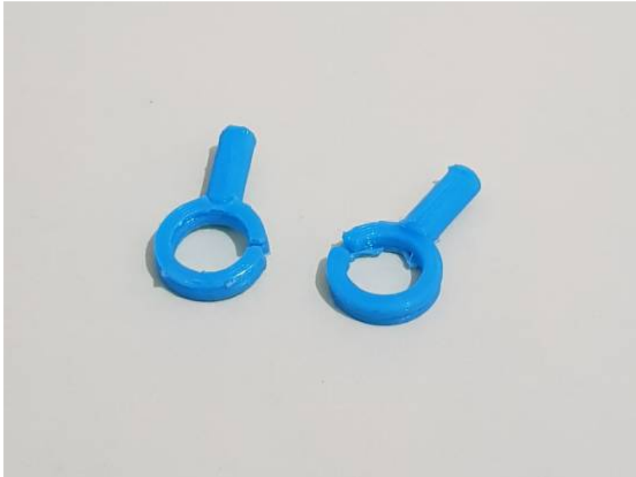
Gambar 4.69: Hasil Uji Coba Material Plastik Pada Komponen Chain Ends Untuk Komponen Tali. (Sumber: Olahan Penulis, 2020)
