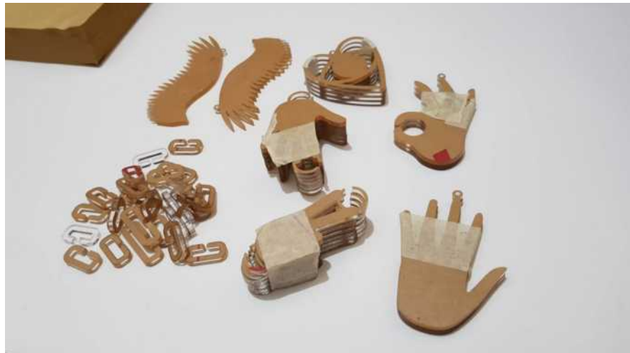
Gambar 4.123: Proses Pengelupasan Stiker Pelindung Pada Tiap Potongan Akrilik. (Sumber: Olahan Penulis, 2020)
