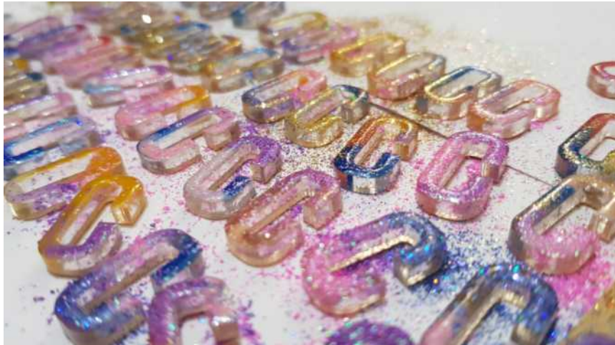
Gambar 4.125: Proses Pengeringan Potongan Akrilik yang Telah Diwarnai. (Sumber: Olahan Penulis, 2020)
