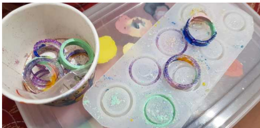
Gambar 4.128: Proses Pembuatan Cincin Menggunakan Sisa Resin dan Cetakan. (Sumber: Olahan Penulis, 2020)
