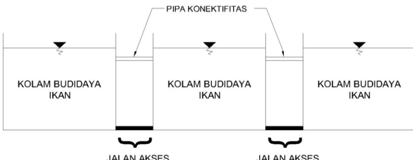
Gambar 4. 42 Potongan Melintang Skema Pipa Penghubung
