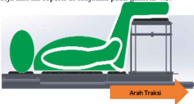
Gambar 4.3 Sketsa Ilustrasi Cara Kerja Alat Traksi Lumbar
