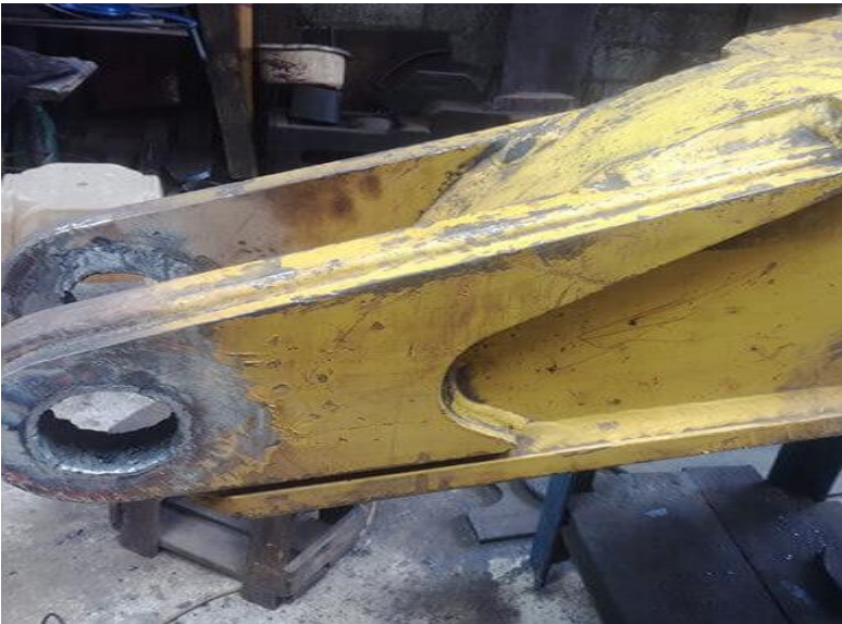
Gambar 2. 13 Kerusakan pada link pin joint arm excavator
