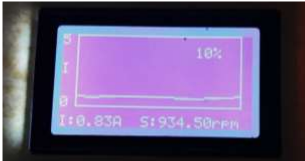
Gambar 4.4 Pengujian Kecepatan Putaran Motor dan Arus Motor Brushless DC tanpa beban dengan nilai Duty Cycle 10%
