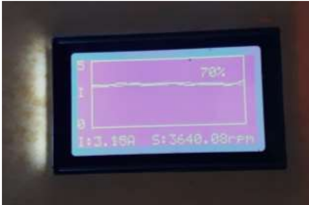
Gambar 4.7 Pengujian Kecepatan Putaran Motor dan Arus Motor Brushless DC dengan beban dengan nilai Duty Cycle 70%
