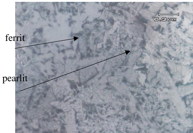
Gambar 4.10 Struktur Mikro Daerah HAZ Suhu 300°C
