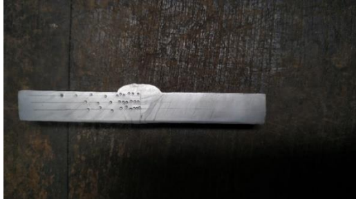
Gambar 4.2 Daerah Indentasi untuk suhu 300°C Tabel 4.5 Data Hasil Uji Kekerasan Suhu 300°C
