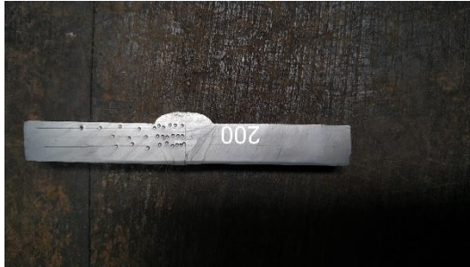
Gambar 4.5 Daerah Indentasi untuk suhu 200°C
