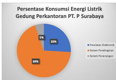
Gambar 4.23 Persentase Penggunaan Energi Listrik untuk Peralatan Elektronik, Sistem Pendinginan, dan Sistem Penerangan pada Gedung Perkantoran PT. P Surabaya Setelah Rekomendasi
