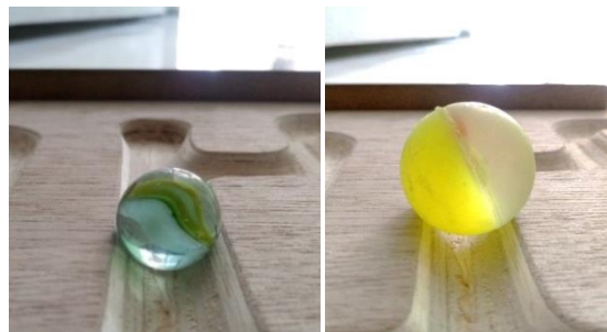
Gambar 4.72. Eksperimen pengaruh lebar alur terhadap jenis serta ukuran bola kelereng (kiri) dan bola bekel (kanan) pada papan multipleks. (Sumber : Penulis, 2019)
