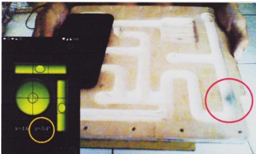
Gambar 4.43. Uji pengaruh sudut kemiringan terhadap laju kelereng (dilingkari merah) yang melaju dengan kecepatan sedang pada kemiringan 4-6 derajat (dilingkari kuning). (Sumber : Penulis, 2019)
