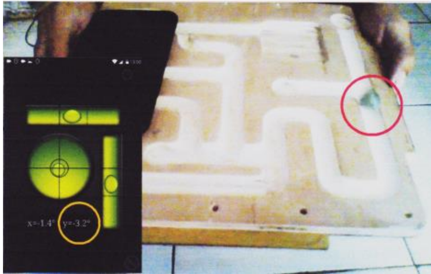
Gambar 4.42. Pengujian pengaruh sudut kemiringan terhadap laju kelereng (dilingkari merah) yang bergerak pelan saat kemiringan sekitar 2-3 derajat (dilingkari kuning). (Sumber : Penulis, 2019)
