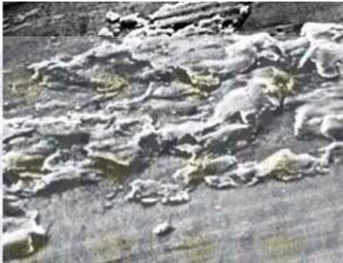
Gambar 2.9 Pengamatan Mikroskopik Keausan Abrasif
