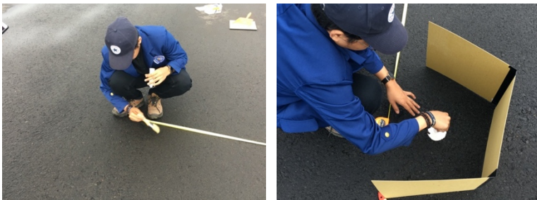
Gambar 5.4 Pengukuran, pembersihan titik pengetesan dan penuangan pasir
