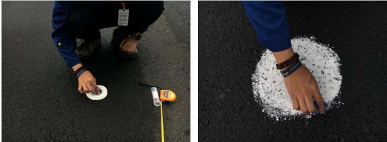
Gambar 5.5 Perataan pasir pada pengetesan
