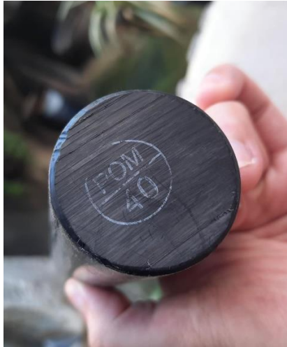
Gambar 3.5 Material Alternatif POM40 (Sebelum Proses Permesinan)
